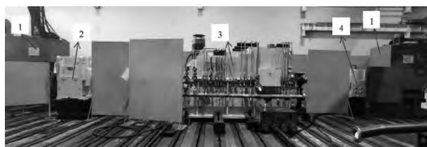
1—电机;2—加载陪试箱;3—主试箱; 4—驱动陪试箱
