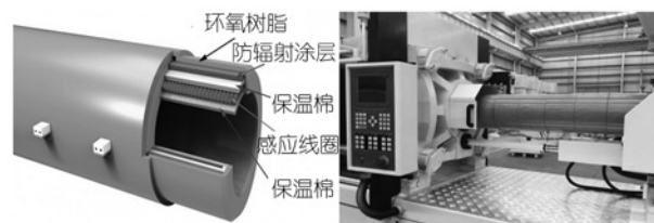
图1 电磁加热圈结构与安装示意图（网图）
