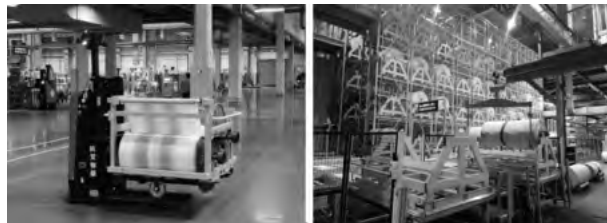
图11 物料小车AGV自动输送实物图
