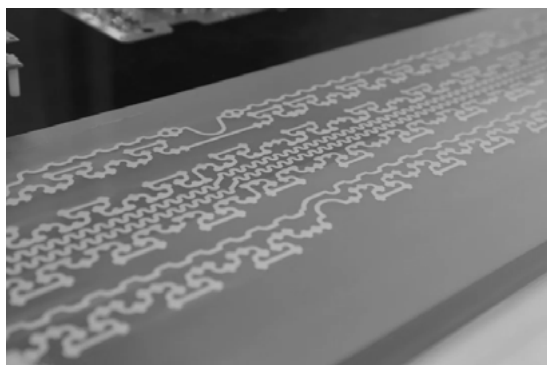
具备出色性能的TPU薄膜是超柔性印刷电子系统的关键基材
