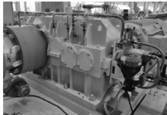
图2 自密封橡胶用交联挤出机组减速箱
