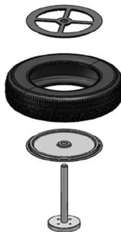
图3 简易立式静平衡机夹装示意图
