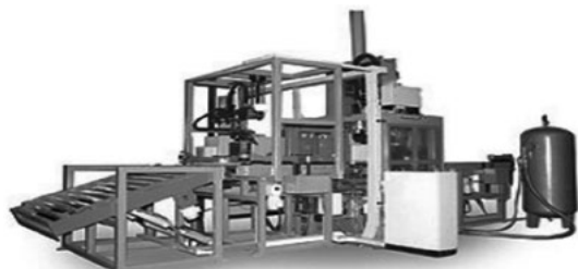
图6 全钢载重子午胎动平衡试验机
