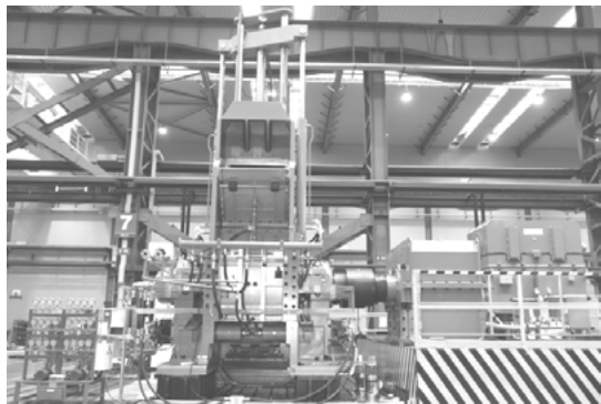
GN700 永磁高压剪切型密炼机
