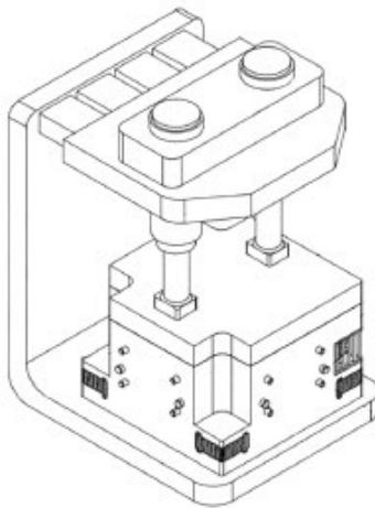
本发明公开了一种EPS塑料泡沫模具，涉及EPS发泡成型技术领域，包括主体机构，主体机构包括支撑架，支撑架的内壁固定连接有下模，支撑架的内壁固定连接有两个液压缸，两个液压缸的伸缩
