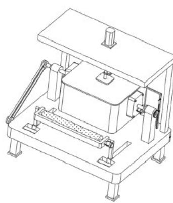
一端安装有密封板，第二旋转柱上安装有带轮，工作台上安装有清理机构，带轮和清理机构传动连接，进一步提高了设备的工作效率，避免了人工烫伤（申请专利号：CN202211441263.7）。
