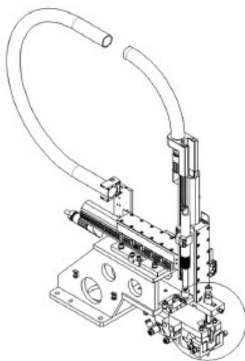
本发明涉及适用于玻璃水接头橡胶圈的上料工装，其由机座、橡胶圈夹持单元以及母座限位单元构成。橡胶圈夹持单元包括第一直线运动元件、第二直线运动元件、承力板以及持料组件。当第一直线运动元件、第二直线运动元件发生动作时，以分别驱动承力板沿着前后方向、上下方向进行位移运动。持料组件插设于承力板上，以对预组装的橡胶圈进行取料操作。母座限位单元由机座进行固定，且布置于橡胶圈夹持单元的正下方。母座限位单元包括有平置板、手指气缸、左置夹爪、右置夹爪以及基准块。当手指气缸发生动作时，以驱动左置夹爪相对于右置夹爪进行相向/相背运动，以实现对玻璃水接头母座的夹紧/放松（申请专利号：CN202011617461.5）。
