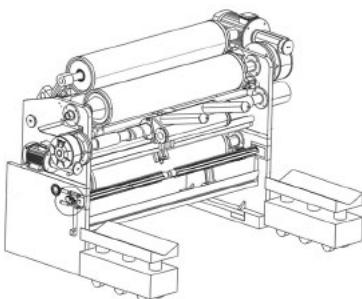
本发明涉及橡胶加工设备技术领域，提出了一种橡胶支座生产用橡胶开炼机，包括架体；炼胶辊转动设置在架体内，成对使用的炼胶辊用于
