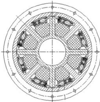
本发明涉及动力传动领域，即橡胶气阻弹性减震器。它包括减震器连接法兰内圈，减震器连接法兰内圈输入侧带有减震器连接法兰，减震器连接法兰内圈输出侧带有减震器输出轴；
