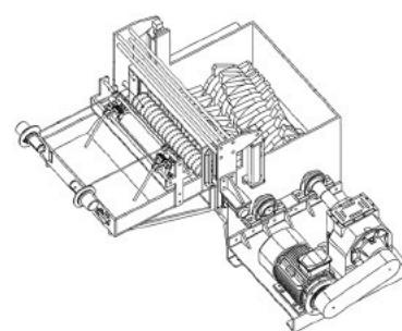
本发明涉及塑料回收技术领域，特别涉及一种废弃塑料回收利用的滚碎处理设备，包括破碎框，破碎框上安装有一对破碎辊，破碎框上连接有固定框，固定框上设有滑动的升降框，升降框上转动连接有表面具有尖刺的进料辊，固定框上连接有放置框，放置框上部转动连接有两组导向轮，放置框上
