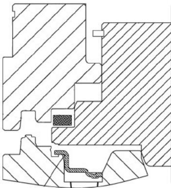
本发明公开了一种新型橡胶转射模具结构，包括上模、下模和活动模芯，上模设置有第一凸台，下模设置有第二凸台，活动模芯设置有第三凸台，上模和活动模芯均设置于下模的上部并且活动模芯设置于上模的内孔中；上模与下模相互靠拢抵接的情况下，上模与活动模芯之间能够形成注料腔，第一凸台、第二凸台和第三凸台之间能够形成流道，第三凸台和下模之间能够形成型腔，注料腔、流道和型腔三者之间连通。本发明还提出一种新型橡胶转射模具结构，使得模具结构简单，模具加工周期短，降低加工成本；硫化成型操作简单快捷，提高生产效率（申请专利号：CN202010744158.5）。
