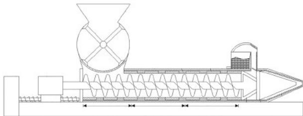
本发明公开了一种橡胶制品生产加工用注塑机，涉及橡胶注塑领域，包括进料组件、注塑组件、搅拌件和气泡收集组件，进料组件包括进料斗和筛板，筛板表面含有不同大小的筛孔，橡胶原料从筛孔进入注塑组件，注塑组件内含有螺杆，注塑组件包括预热段、加热段和进料段，筛孔将大块橡胶原料送至预热段前端，将小块橡胶原料送至预热段后端，螺杆四周安装加热环，加热环外侧设置散热管，散热管包裹注塑组件，加热环将固体原料加热为液态原料，螺杆一端安装搅拌件，将液态原料中的气泡搅出，搅拌件的输出端安装气泡收集组件对气泡进行收集，防止气体逸散对人体造成伤害，提高橡胶制品成型质量（申请专利号：CN202411452927.9）。
