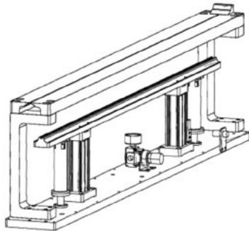
及O型密封圈加工设备技术领域。一种橡胶密封圈毛边去除装置包括托举板、保护板和切割部，保护板上设有沿长度方向设置的用以定位密封圈的槽，槽的槽底设有沿保护板长度方向设置的缝隙；切割部设置在保护板上，并且切割部沿缝隙的长度方向由缝隙的一端至另一端往复移动；托举板托举部分密封圈向槽移动，以使密封圈外壁贴合在槽内，并且密封圈加工过程中所产生的毛边穿过缝隙，毛边凸出于保护板，切割部沿缝隙行走，切割毛边。本发明可快速修理大型非标品O型密封圈的毛边，同时采用保护板固定和定期更换设置在切割部上的刀片的措施，保证修毛边的安全性和高效性（申请专利号：CN202110933196.X）。
