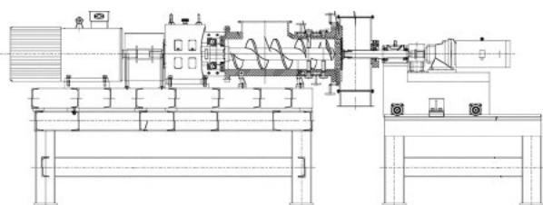
本发明公开了一种丝状特种异戊橡胶造粒设备，包括熔融挤出装置、切粒装置和驱动装置，熔融挤出装置包括筒体、螺杆和模板机构，筒体上设有进料口，筒体一端与模板机构相连，另一端处设有驱动装置，螺杆设于筒体内，螺杆与驱动装置的输出端相连，切粒装置包括切粒电机、切刀轴、切刀、切粒箱和密封部件，切粒电机与切刀轴相连，切刀轴上设有切刀，密封部件套设于切刀轴上，切粒箱的一侧与模
