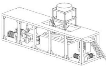
本发明公开了一种橡胶沥青加工用混合搅拌装置，涉及橡胶沥青加工技术领域，解决了橡胶粉末会由于水蒸气结团黏附在导管管口处，导致导管管口处的口径变小，从而影响了料斗的正常送料的问题，包括混合罐，混合罐的上侧安装有料斗，料斗的下端固定安装有与其相互连通的导料管，且导料管上安装有电磁阀，混合罐的上端固定安装有两个呈对称分布的电机，电机的驱动端固定连接有搅拌轴；本发明通过安装清理组件，搅拌轴通过第二齿环驱动清理组件中的第一齿环及刮条旋转，刮条在贴合出料管内壁转动的过程中，能够刮除出料管内壁上附着的水蒸气，从而能够有效避免橡胶粉末由于水蒸气结团黏附在出料管的管口，影响出料管送料（申请专利号：CN202510232227.7）。
