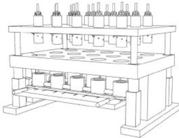
本发明公开了一种橡胶密封件加工用成型模具，属于橡胶密封件生产技术领域，本发明是通过设置内外嵌套且可上下升降运动的中空模套以及模芯，中空模套由前后对称设置的定模套、动模套组成，在注塑时，模芯与中空模套内的多对注塑腔之间构成多个相互不连通的注塑模槽，通过多组注料管、注料腔配合结构分别向多个注塑模槽同步注入橡胶材料，注料工作完成后，启动限位套处的电磁环，推料锥朝限位套一侧运动并与之相密合，一方面将注料腔多余橡胶材料推动至注塑模槽，另一方面实现注塑模槽与注料腔无间隙配合，每个注塑模槽形成的密封件为独立个体，待开模后，动模套向外脱离定模套，驱动定模套向下朝落料口翻转，在重力作用下实现集体脱模（申请专利号：CN202411546190.7）。
