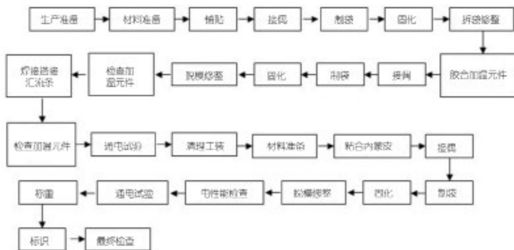
图 2 防冰前缘制造工艺流程
