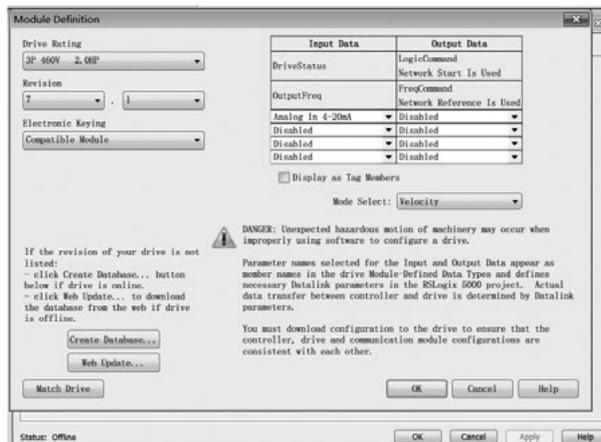
图3 PowerFlex 525EENET 设置模块设置
