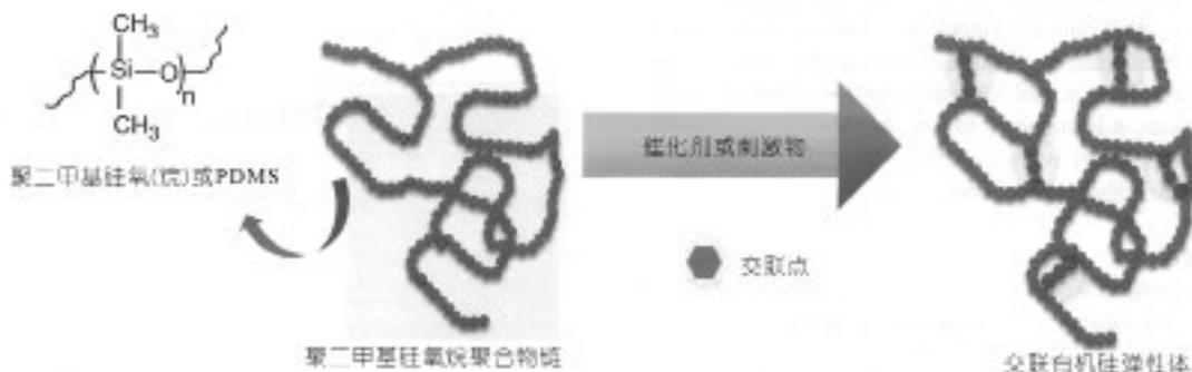
图1 聚(二甲基硅氧烷)或PDMS的化学结构和有机硅聚合物的交联示意图
