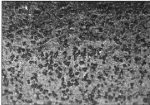
图(15) ARC-13/PD-UV-HSLV试品9估计干膜厚度约为17  $\mu\text{m}$
