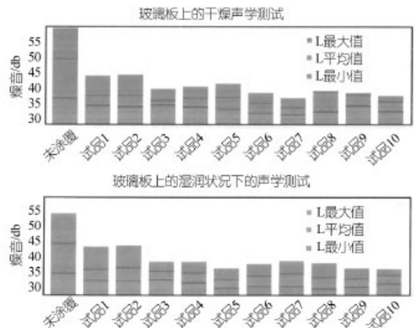
图 5 在不同干膜厚度条件下, 每个工业涂层试品在干和湿条件下对玻璃面板的声学测试结果
