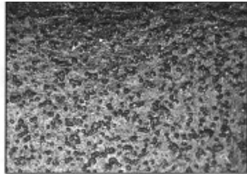
图(14) ARC-13/PD-UV-HSLV试品估计干膜厚度约为14  $\mu\text{m}$
