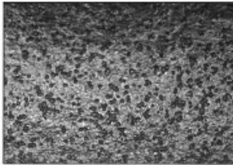
图(13) 试品7估计干膜厚度约为13  $\mu\text{m}$
