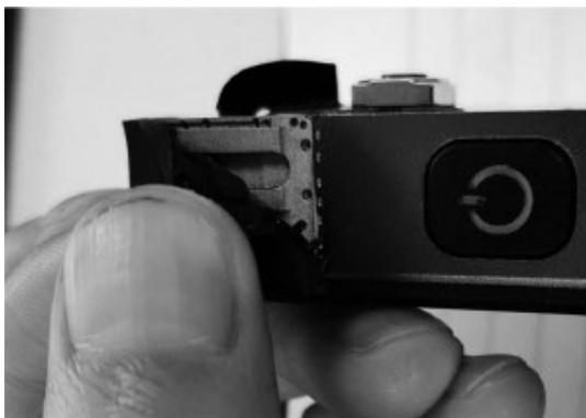
图 10 硅橡胶注塑铝合金骨架
