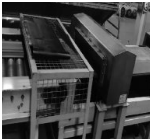
图5 拾取岗位金属杂物检测
