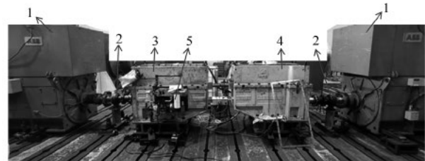
1—电机；2—扭矩仪；3—主试箱；4—陪试箱；5—冷却装置
