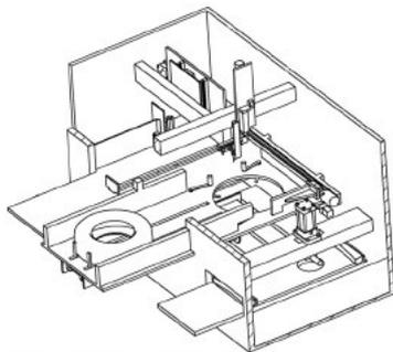
本发明公开了一种橡胶轮胎钢丝回收装置，涉及废旧轮胎处理技术领域，包括回收仓，回收仓内设置工作台一、工作台二、工作台三；工作台一设有环切平台，环切平台的前侧设置将轮胎运至环切平台上方的输送件一，环切平台的上方设有分离胎侧与胎面的胎侧分离机构；环切平台的后侧设置输送件二将胎面从环切平台传递至工作台二，工作台二的上方设有切除钢丝网外侧橡胶的钢丝网回收机构；环切平台的下方设置输送件三将轮胎胎侧传递至工作台三；工作台三的上方设有碾碎钢圈四周附着橡胶的钢圈回收机构；工作台二、工作台三分别设置清理台面的输送件四、输送件五；本发明的回收过程省时省力，回收的钢圈、钢丝网完整性好，便于资源回收利用和后续加工（申请专利号：CN202311608284.8）。
