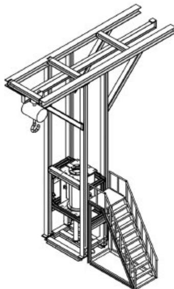
本发明为一种电缆中间接头橡胶件的内模自动装脱模装置，包括电源、控制器和机架，其特征在于：还包括设于机架上的内模合模机构，内模合模机构包括合模架、分别设于合模架上顶面框架和底面框架上且结构相同的内模拆分及固定机构，内模拆分及固定机构包括一
