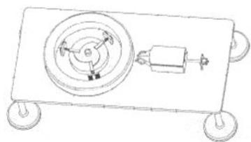
本发明公开了一种轮胎的橡胶剥离装置，涉及废旧轮胎处理技术领域，包括工作台和废旧轮胎，工作台的上表面
