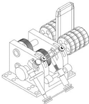
本发明公开了一种可快速调节输送间距的橡胶板输送导向装置，包括支撑框架、固定安装板、控制调节装置、输送导向机构和橡胶板，固定安装板对称固定安装在支撑框架的底端两侧，
