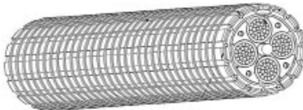
本实用新型涉及电缆技术领域，且公开了一种阻燃硅橡胶电缆，包括阻燃硅橡胶外护套，阻燃硅橡胶外护套的内表面固定连接屏蔽层，屏蔽层的内部卡设有加强架，加强架的外表面均匀卡设有绝缘层，绝缘层的内部均匀设置有导体，阻燃硅橡胶外护套的一侧均匀开设有贯穿孔，贯穿孔的内部均匀贯穿有软钢丝。本实用新型通过加强架的设置对该电缆内部起到支撑的作用，以提高整体的强度，避免轻易受到挤压而造成对导体的压迫，起到良好的保护作用，同时通过凹槽的开设避免影响整体的弯折性能，并通过防护片对电缆进行防护，避免电缆轻易受到磨损，同时通过软钢丝以避免阻燃硅橡胶外护套持续开裂，最终实现良好的强度和防护性能（申请专利号：CN202321656144.3）。
