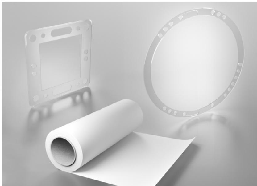
Ultrason®系列材料非常适合用作碱性水（AWE）、质子交换膜（PEM）和阴离子交换膜（AEM）电解槽各种部件中金属材料的替代选择。非晶聚合物具有出色的耐高温性和耐化学性，其在极端苛刻条件的卓越表现包括适用于结构件加工的热塑性和适配隔膜的高纯度稳定性。Ultrason®系列材料的机械性能不受温度影响，因此适用于当前（90°C）乃至未来（> 120°C）的电解槽。
