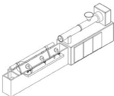
本实用新型公开了一种橡胶管注塑成型机，涉及橡胶管成型设备技术领域，针对现有的橡胶管注塑成型机的冷却池中会蓄积有残渣，这些残渣可能会附着在橡胶管胚上，从而导致影响橡胶管胚的后续加工，进而会影响橡胶管的产品质量的问题，现提出如下方案，包括注塑成型机本体和冷却池，冷却池的内壁上固定设置有过滤板、隔板和底板，底板上固定设置有抽水泵，抽水泵上连通有两段水管，两段水管中的一个的一端延伸至底板的下方。本实用新型结构设计合理，使用方便，通过对冷却水进行过滤循环使用，从而能够防止橡胶管胚上附着残渣，从而有效的保障了橡胶管胚的后续加工效果，保证了产品质量（申请专利号：CN202321677680.1）。
