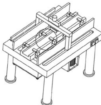
本实用新型属于橡胶密封条加工技术领域，尤其涉及一种具有收集废料功能的橡胶密封条加工用定长裁剪装置，包括操作台，操作台上表面设置有裁剪装置，裁剪
