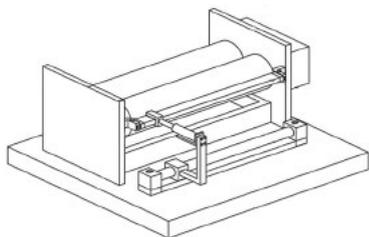
定组件的中间活动连接，连接有刮板，支架的一侧安装有清洁组件，本实用新型的有益效果是：刮板位于辊轮的一侧对其表面刮料处理，刮下的物料一部分会向下掉落进入集料盒内收集，另一部分会堆积或粘在刮板的表面，此时可以启动无杆气缸带动导向滑块和支板往复移动，接着启动电动推杆推动移动板，使移动板中间的插槽插接到刮板上，当移动板被驱动左右往复移动时，移动板可以利用清洁毛刷对刮板的表面进行清洁，避免了物料粘黏在刮板的表面（申请专利号：CN202321202623.8）。
