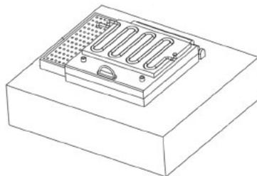
本实用新型涉及硅橡胶技术领域，且公开了一种硅橡胶注塑成型模具，包括模具本体，模具本体包括底台，底台的顶部固定连接有以下模具，下模具的顶部安装有上模具；上模具的顶部安装有冷却机构，冷却机构包括导热板，导热板的底部与上模具的顶部固定连接。该硅橡胶注塑成型模具，通过上模具带动转动板移动，而转动板带动转动座移动，此时转动座在转轴的表面进行转动，直至上模具闭合于下模具的顶部，然后通过入水管将冷却水倒入换热管的内部，由换热管对导热板内的热量进行冷却，能够解决了现有的注塑模具冷却速度较慢，这样会影响硅橡胶成型速度，以至于影响硅橡胶生产速度的问题（申请专利号：CN202321897235.6）。
