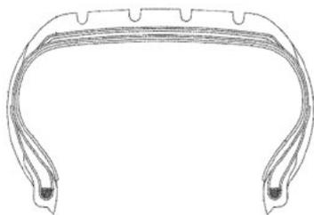
本发明提供了一种翻新轮胎的过程，该过程包括提供轮胎骨架、提供具有第一和第二平面表面的固化橡胶部件、提供缓冲胶、将
