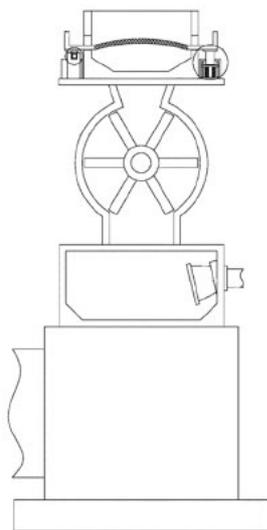
的顶端安装有切粒机本体，切粒机本体的顶端安装有吹粉腔，吹粉腔的一侧安装有吹风口，下料管的顶端安装有以下料腔，下料腔的内部设置有以下料机构，下料腔的顶端安装有进料腔，进料腔的内部设置有筛选机构；通过在进料腔的内部设置有筛选机构，利用筛选机构的筛选板、储料腔、安装板、第一伺服电机、偏心轮、安装腔、伸缩弹簧、活动杆、限位杆和限位套之间的相互配合，可对粉料进行筛选处理，将一些较大的杂质筛选出来，而且还可将结块的粉料与筛选板之间抖动，将粉料震开，从而大大提高了该装置在使用时的实用性（申请专利号：CN202321654512.0）。
