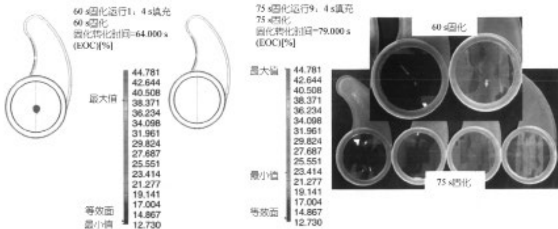
图11 实际和模拟零件之间的空隙比较；固化时间为60秒对比75秒
