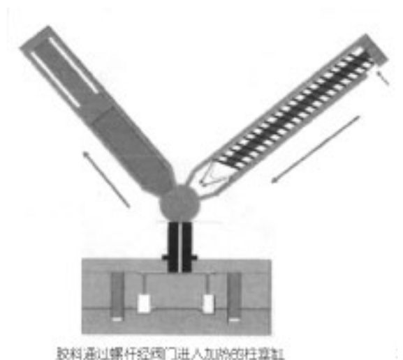
胶料通过螺杆经阀门进入加热的柱塞筒
