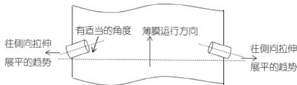
图2 夹持展平辊示意图
