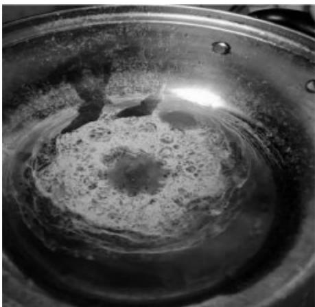
图 3 动力循环水蒸发后的残留物质
