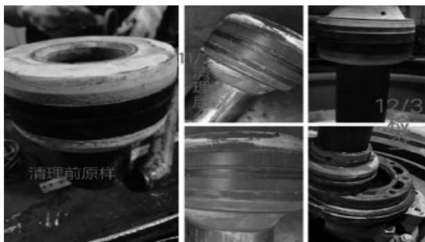
图 4 J8 机台中心机构结垢情况对比图
