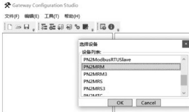
图 8 网关调试软件中设置设备型号
