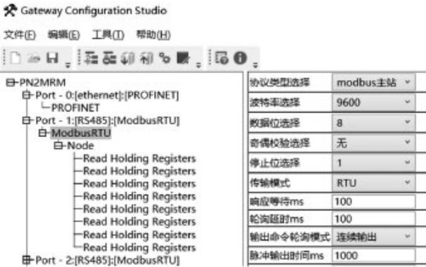
图 11 网关调试软件中设置与电表对应的 Modbus (RS-485) 参数
