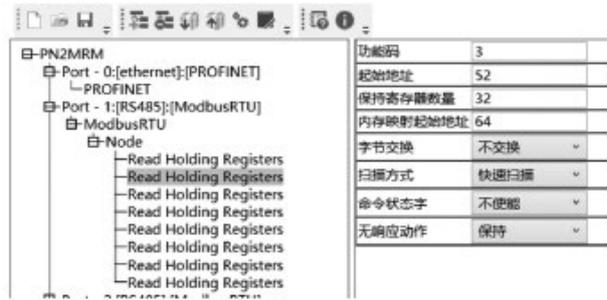
图 13 网关调试软件中设置电表通讯地址 52~83
