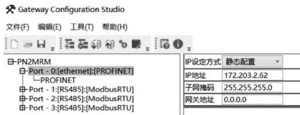
图 9 网关调试软件中设置 PLC 的 IP 地址
