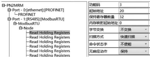
图 12 网关调试软件中设置电表通讯地址 20~51
