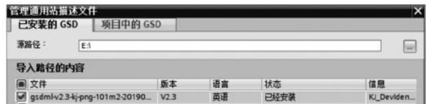
图 4 北京开疆智能 KJ-PNG-101 型协议转换网关的 GSD 文件
