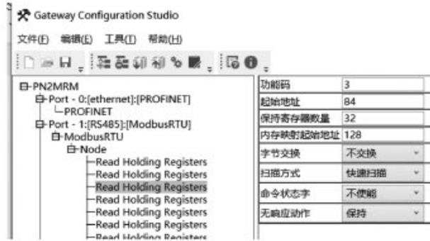
图 14 网关调试软件中设置电表通讯地址 84~115
