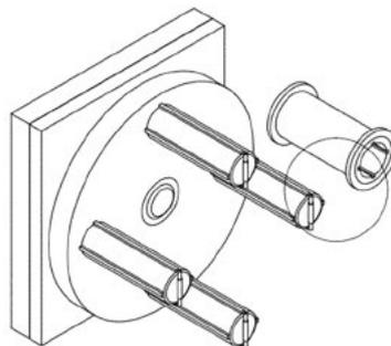
本实用新型公开了一种ASA塑料膜连续生产卷绕设备，包括支撑台板，支撑台板一侧外壁的轴心处通过轴承活动连接有转盘，且支撑台板
