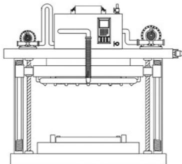
本实用新型提供一种便于橡胶冷却成型热压机。便于橡胶冷却成型热压机包括：热压机本体，热压机本体包括下压板、从动板和上压板，从动
