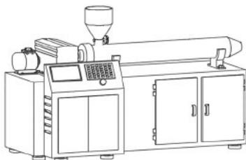
本实用新型提供一种改性塑料用自动挤出机，包括：工作台和减速箱，工作台外部的一侧通过合页铰链
