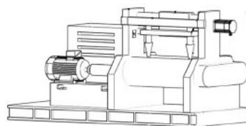
一组辊筒的表面抵触，转动轴的顶端穿出旋转台并固定连接有齿轮，两组安装架之间对应齿轮固定连接有齿条，齿条与齿轮啮合连接。本实用新型涉及炼胶装置技术领域，其具有减少人力、加快工作效率的优点（申请专利号：CN202221647372.X）。
