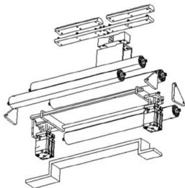
本实用新型提供一种橡胶轮胎胎胚卸胎称重装置包括底座、机架、托举件、称重件；底座前后两端分别下沉设置有台阶；机架设置在底座上侧，机架中间设置镂空部；升降驱动
