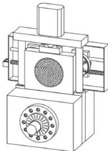
本实用新型涉及造粒机设备领域，尤其是涉及的是一种橡胶颗粒造粒机的换网器，包括换网器主体、套
