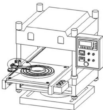
工作台的底部与升降支座顶部的升降端固定连接，移动工作台的顶部固定连接成型模具，移动工作台的一侧分别固定连接直齿条和电磁锁。本实用新型所设置的
