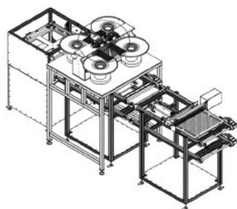
本实用新型公开了一种高速橡胶原料自动排料机，包括上层皮带输送线，上层皮带输送线的下方设置有下层皮带输送线，下层皮带输送
