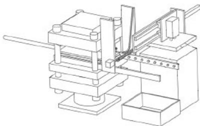
本实用新型公开了一种环形橡胶自动硫化装置，涉及橡胶硫化技术领域。包括硫化机、模具、上料装置、下料装置和下料箱；硫化机包括上加热平板和可升降的下加热平板；模具滑动设置于下加热平板上；下料装置包括旋转气缸和与旋转气缸连接的转轴；转轴上设置有多个平行并间隔分布的刮针；上料装置包括上料平台，上料平台远离硫化机的一侧设置有气缸安装板；气缸安装板上设置有第二气缸；第二气缸的伸缩杆连接有横向运动板；横向运动板上设置有第三气缸；第三气缸的伸缩杆连接有用于取放料的吸盘。
