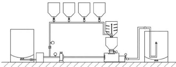
料系统，包括母液罐、配料仓、混料装置和储液罐，母液罐通过输送泵配合管道串联若干配料仓后，依次连接混料仓和储液罐，混料装置包括第一混料仓、中转仓、第二混料仓、混料管、混液管，第一混料仓设置于中转仓顶部，在第一混料仓与中转仓之间设有控制阀，中转仓设置于第二混料仓顶部，在中转仓与第二混料仓之间设有控制阀和流量计，第一混料仓上设有混料管串联各个配料仓后，依次连接输送泵、母液罐，第二混料仓一端设置配液管连接输送泵，另一端通过混液管连接储液罐。本实用新型集配料、混合、输送于一体，能够实现橡胶生产原料自动配制，效率高，且大大提升了产品质量稳定性(申请专利号：CN202222374510.8)。
