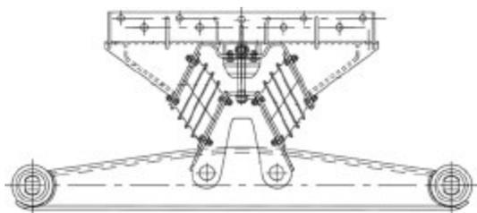
本实用新型提供了一种轻量化高强度结构橡胶悬架，它包括鞍座支架总成和均衡梁总成，均衡梁总
