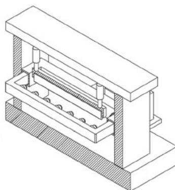
本实用新型提供一种再生橡胶出片机切片装置，涉及再生橡胶出片机技术领域。一种再生橡胶出片机切片装置包括底座，底座的顶部安装有对称分布的侧板，两块侧板之间升降设置
