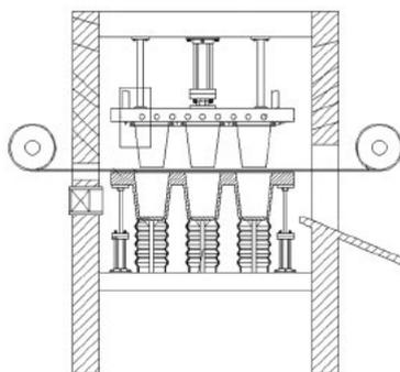
本实用新型公布了一种塑料杯生产用自动出模装置，包括机架，机架中部设有固定板，固定板上设有第一安装板，第一安装板上设有第二安装板，第二
