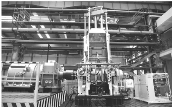
图3 超大型串联密炼机
