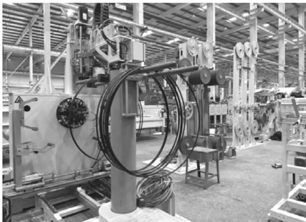
图6 单机3-一拖N钢丝圈缠绕生产线
