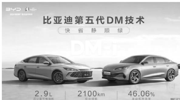
新品采用了以电为主的动力架构，插混专用高效发动机实现了46.06%的热效率，EHS电混系统通过极致的结构设计，功率密度提升70.28%，并大幅减少能
