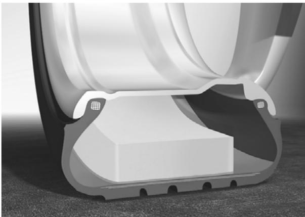
米其林 Acoustic 静音技术轮胎、佳通 Magic Sound 静音绵技术、德国马牌 ContiSilent 静音技术、倍耐力噪音消除系统™ (PNCS) .....如今，静音棉轮胎相关技术已经成为各大头部胎企的必备技能。
