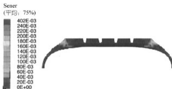
图12 带束层膨胀率为1.05时的胎肩应力分析
