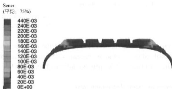
图11 带束层膨胀率为1.02时的胎肩应力分析
