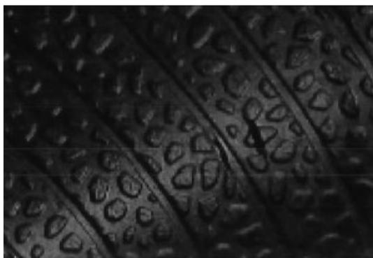
图9 带束层膨胀过大导致的内部裂纹
