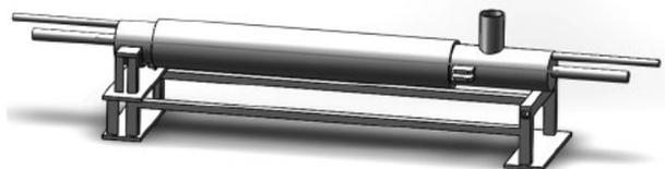
图 2 胶粉电磁裂解设备布置图
