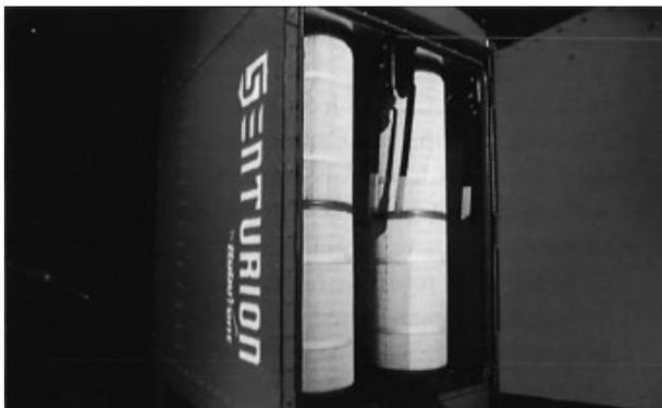
图2 筒式集尘器可有效控制大多数应用场合的炭黑
