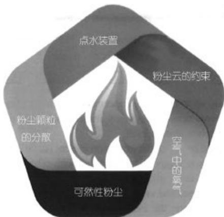
图1 粉尘火灾和爆炸五边形
