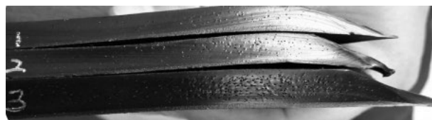
图2 胎面半部件横截面气孔图示
