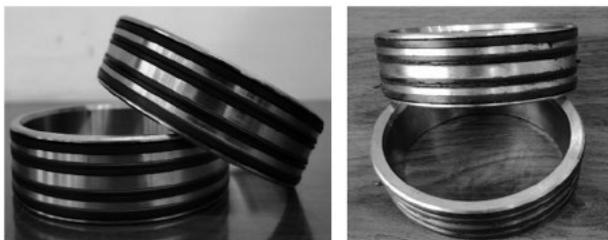
图 12 3.88 in 组块密封单元试验前后对比
