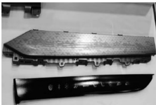
图6 激光打标塑件纹理示意图
