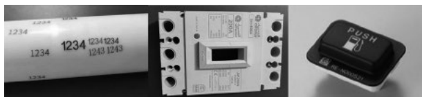
图5 激光打标塑件示意图(网图)
