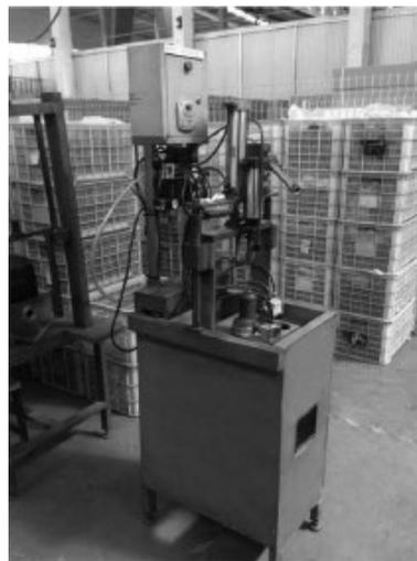
图2 汽车油气分离器密封性检测设备样机
