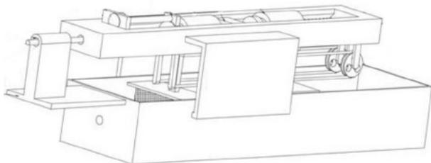
本发明公开的一种生物降解塑料制品回收装置，双向推挤清洁装置包括用于支撑的双向推挤清洁箱，双向推挤清洁箱与支撑座上端相连，双向推挤清洁箱内活动安装有用于推动塑料管前进的双向推挤组件一和双向推挤组件二，双向推挤清洁箱内还安装有对移动的塑料管进行清洁的清洁组件和用于传递驱动力的导向组件，导向组件设于双向推挤清洁箱底壁上，导向组件的活动端分别与双向推挤组件一和双向推挤组件二相连。本发明属于塑料回收技术领域，尤其涉及一种生物降解塑料制品回收装置，尤其针对管状塑料，实现推动进料、清洁、切割一体化服务，同时能够对切割后的塑料管再次进行清洗处理（申请专利号：CN202311456528.5）。
