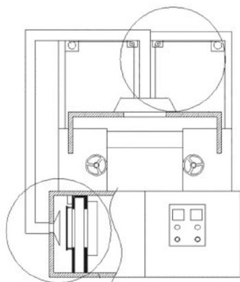
本发明涉及机械设备领域，具体为一种橡胶开炼设备，包括工作箱，工作箱上靠近两侧的位置设置有支撑体，两个支撑体之间设置有辊轴，辊轴连接有驱动装置，还包括罩体，罩体的顶端设置有进料口，
