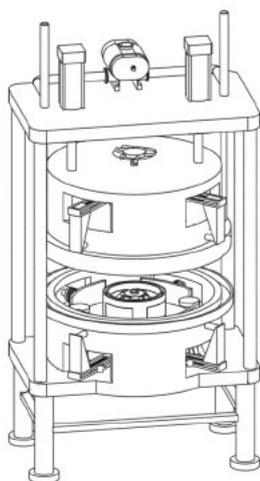
本发明提供了一种用于橡胶轮胎加工的硫化设备及其使用方法，涉及橡胶轮胎加工设备技术领域，包括主体，主体的顶部安装有支腿，且主体的顶部安装有下板，且下板的上方安装有上板，下板以及上板的中间位置安装有螺纹杆，并且主体的顶部安装有固定机构；固定机构，固定机构内的载板分别安装在下板以及上板中间位置螺纹杆的外侧；收集组件，收集组件安装在主体的上方，且收集组件位于固定机构的上方。内板卡合安
