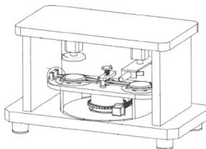
本发明公开了一种橡胶膜片加工抗挤压性形变检测装置，包括底板、支撑台、橡胶膜片本体，底板顶端固定安装有支撑竖板，支撑竖板顶端固定安装有顶板，底板顶端通过轴承一转动连接有转柱，支撑台固定安装在转柱顶端，橡胶膜片本体的数量为两个，两个橡胶膜片本体分别放置在支撑台顶端表面靠近两侧，支撑台顶端设置有固定机构，支撑台与转柱之间设置有吸附机构，转柱与底板之间设置有转动机构，通过设置固定机构，可以使连板带动压条一与压条二向下移动，使压条一与压条二对两个橡胶膜片进行同时夹紧，从而提高人员的对橡胶膜片本体的安装固定效率，进而提高装置的工作效率，结构简单，实用性强（申请专利号：
