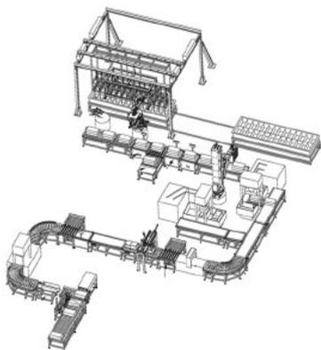
本发明公开了一种天然橡胶自动化包装生产线，包括自动吊模机、抓胶上料机器人手、第一重量检测机、压包上料机器人手、液压打包机、金属检测机、橡胶切割机、内包装膜包装封口机、外包装袋包装机、外包装袋封口预压机和外包装袋缝纫机。本发明是一条连续的橡胶自动化包装生产线，集自动吊模、抓胶上料、流水线运输、重量检测、橡胶压实、金属检测、橡胶切割、内包装封装、外包装封装、外包装封口预压和外包装车缝封口等多种功能为一体，无需要人工对橡胶进行转移，生产效率高，降低了劳动强度和成本，提高了安全性，满足企业的规模化生产（申请专利号：CN201910451041.5）。
