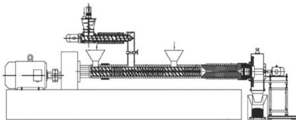
段双螺杆挤出机、造粒包装装置三部分组成，多进口口多段双螺杆挤出机包括多进口口多段双螺杆主体部分和冷却挤出装置，其中胶粉单螺旋塑化装置的第一出料口通过连接阀门与多进口口多段双螺杆挤出机第二进口口相连接，多进口口多段双螺杆挤出机尾端部位安装有造粒包装装置。本发明实现了胶粒微波加热/双螺杆剪切得过脱硫胶粒、胶粉电磁热/单螺旋塑化得半脱硫胶粉与胶粉混炼制得废旧橡胶再生混炼胶的连续化生产，产品绿色环保且性能优异，同时其性能可根据实际需求进行调配混炼，产品可广泛应用于轮胎、胶板等橡胶制品、防水卷材及道路沥青等领域中（申请专利号：CN201710451139.1）。
