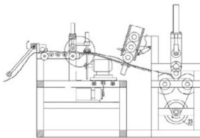
与卷收装置的进料端之间设有导料板，裁剪装置包括裁剪机架、裁剪工作台、横向裁剪机构和齐边裁剪机
