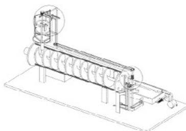
本发明涉及造粒机领域，尤其为一种橡胶防护蜡的挤压造粒装置及使用方法，包括底板和输送板，底板上端固定连接挤出筒，挤出筒上端左侧中部连通并固定连接进料筒，
