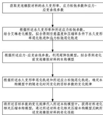
速退化模型；根据应力应变曲线参数，利用超弹性模型，拟合得到老化前发泡橡胶材料的本构模型；根据永久变形率退化轨迹和应力松弛退化轨迹，确定本构模型中的随老化时间变化的目标参数的变化规律；将目标参数的变化规律代入本构模型中，获得材料老化相关压缩本构模型。如此，通过搭建的材料老化相关压缩本构模型，反映材料在老化过程中的性能的变化（申请专利号：CN202110934014.0）。
