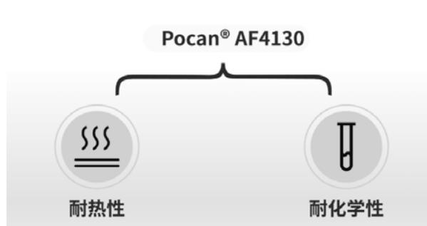
在设计和生产电动汽车时，汽车原始设备制造商采用的工艺流程也是迥然不同。工程热塑性塑料（如PBT和PBT混合材质）在电动汽车电池领域有着广泛的应用潜力。虽然汽车电气和电子元件都广泛使用PBT材料，但要找到一种专门用于电池组件的材料却是良材难求。因此，恩骅力和海拉公司携手合作，打造了适合电池管理单元和电池监测单元外壳的Pocan® PBT AF4130材料，满足电池的耐热性和耐化学性特定需求。
