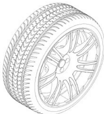
本实用新型涉及防弹减噪轮胎技术领域，具体为一种防弹减噪橡胶轮胎，包括轮毂，轮毂的外圈上安装有轮胎组件，轮胎组件包括有钢丝圈，钢丝圈的侧壁设置有三角胶条，钢丝
