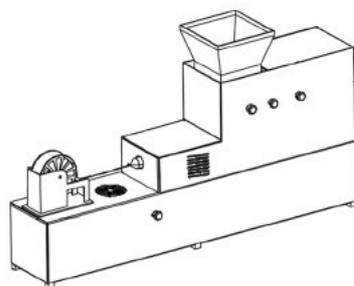
置本体的顶部焊接有进料斗，进料斗呈外喇叭状，橡胶管生产装置本体内部安装有破碎装置，破碎装置包括二号电机、皮带、驱动齿轮、随动齿轮、右搅齿，通过破碎装置等结构的设置，二号电机带动皮带运动，皮带带动辊道转动，辊道带动驱动齿轮转动，驱动齿轮带动随动齿轮转动，辊道和齿轮轴同时带动左搅齿和右搅齿转动，将塑料原料搅碎成精细原料，使得搅碎效率大大提高，还提高了设备的可用性(申请专利号：CN202321667918.2)。
