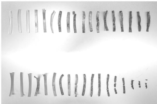
为了评估材料的生物降解性，将塑料条放置在微生物活性和无菌堆肥环境中。堆肥装置保持在37°C，相对湿度在44%至55%之间。堆肥中的水和其他营养物质促使孢子在塑料条内发芽，在五个月内降解90%。
