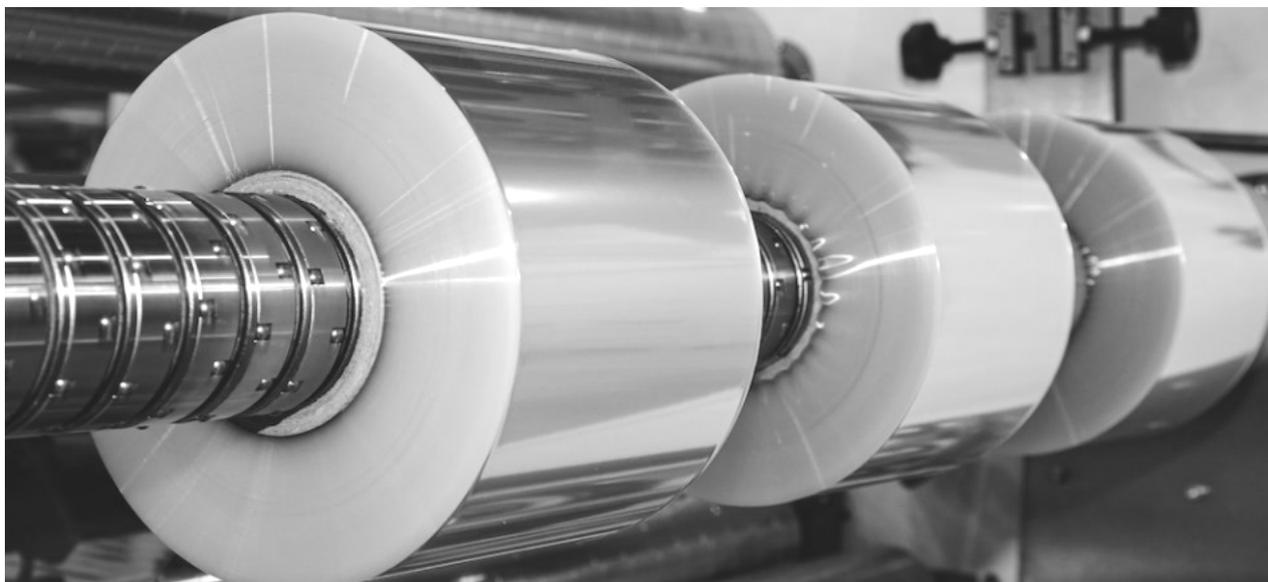
与市场上的竞争解决方案相比，其对氧气、二氧化碳和水蒸气透过的抵抗力高出30%。与尼龙6和尼龙66相比，它们表现出更高的耐温性、更低的吸湿性和“更好”的性能保持性。NY-Clear也可用于高温应用，例如烤箱袋。与许多高性能工程塑料相比，非晶态尼龙以其尺寸稳定性、高T<sub>g</sub>、热变形温度（HDT）、在高温下的低蠕变性以及良好的耐化学性而闻名。
