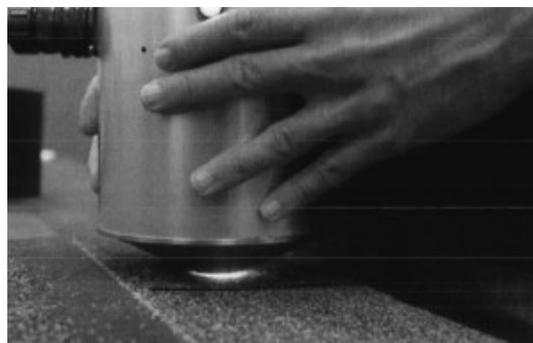
图10 在瓷砖上使用的太阳能反射仪装置
